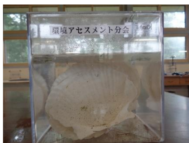
写真-1 水質浄化実験（ホタテ貝）
