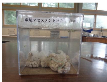
写真-2 水質浄化実験（かき殻）
